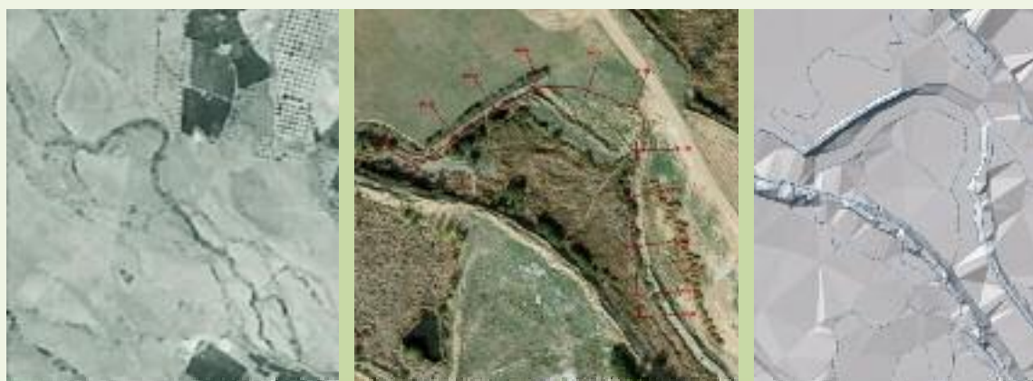
Figura 4.17 La primera imagen, correspondiente al vuelo aéreo realizado en 1956, muestra el aspecto original del meandro. La segunda imagen muestra el aspecto actual del meandro. Gracias a la ayuda de un modelo digital de elevación del terreno, se ha reconstruido el meandro y se han calculado los volúmenes de tierra a mover y el perímetro a reperfil para alcanzar la imagen objetivo (imagen derecha).
